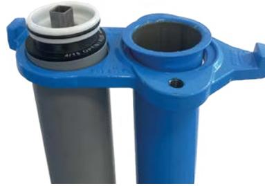
8. Vierkantstange mit Kuppelmuffe (8) aufstecken und mit Gewindestift (10) in der Arretierung der Vierkantstange festschrauben.
