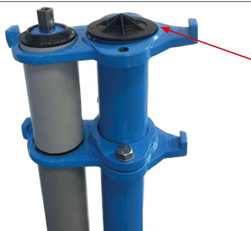
15. Klauenkupplung des UFH wieder mit Sechskantschrauben und Unterscheiben auf Kupplungsplatte aufschrauben. Drehmoment 110 Nm.
