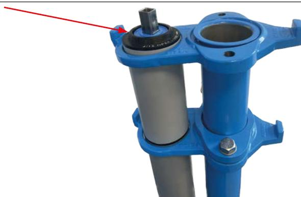
14. Zweite Schmutzdichtung (4) zentrisch auf das Standrohr der Verlängerung auflegen.
