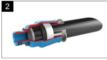
Abziehschalen Best. Nr. 601-00 vollständig einschieben. Rohr drehend herausziehen.
