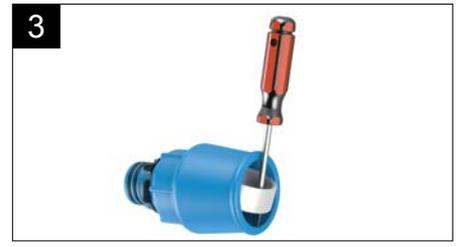
Bei erneuter Verwendung des Fittings den Klemmring austauschen. O-Ring-Dichtung begutachten und evtl. ebenfalls austauschen.
